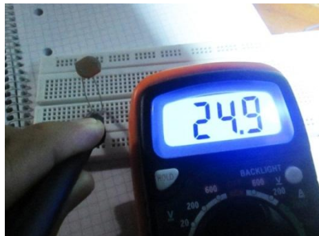
Gambar 6.3 Resistansi LDR ketika lampu dihalangi kertas
